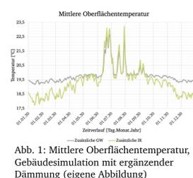
Abb. 1: Mittlere Oberflächentemperatur, Gebäudesimulation mit ergänzender Dämmung (eigene Abbildung)
